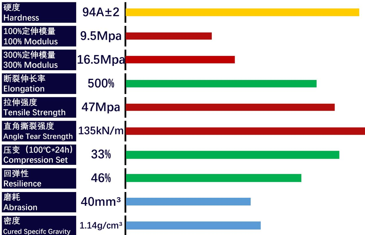
\*以上技术参数均为采用DIN标准，在实验室中测试所得，样件测试前在120°C温度下处理24h
